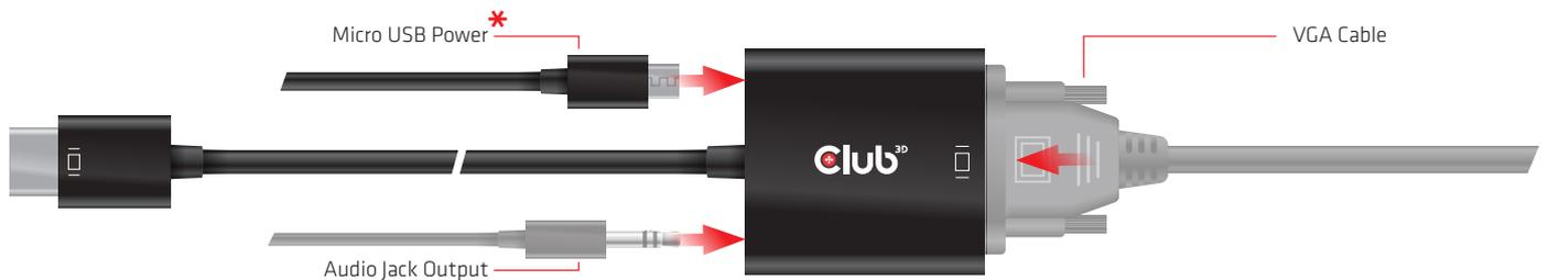
\* Außerdem können Sie, falls die HDMI™ Quelle nicht genug Strom zur Verfügung stellen kann, ein Ladegerät oder einen Computer mit der Micro USB-Buchse verbinden, um Strom für den Adapter zu liefern.
